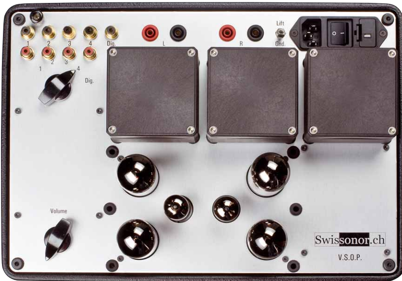
Sechs Röhren, drei Trafos und die üblichen Bedienelemente, nur eben einmal ganz anders aufgebaut
